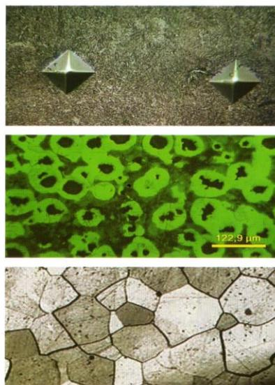
Análises metalográficas com software quantitativo e qualitativo, de fases, tipo de estrutura, determinação de tamanho de grão, camada descarboneta e muito mais.
